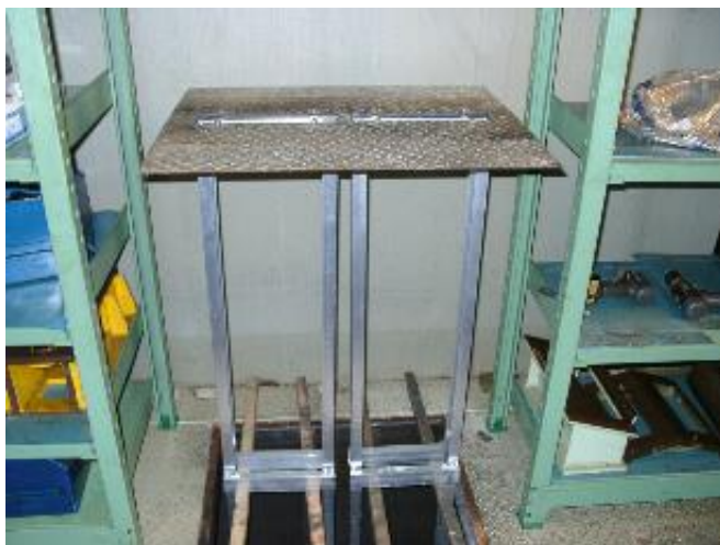
鉄板とオイルアタッカーの設置状態
